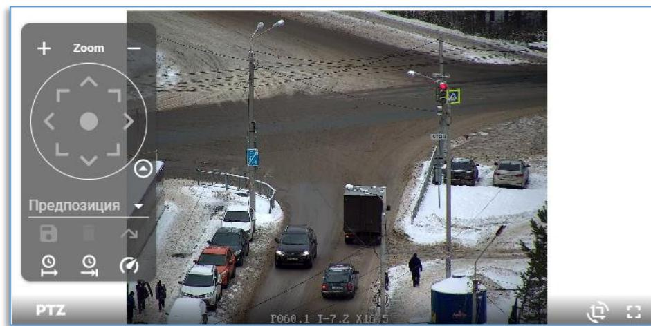
Кнопка **④** переключает меню PTZ в упрощённый режим. В упрощённом режиме отображаются только кнопки для поворота камеры и приближения/отдаления.
