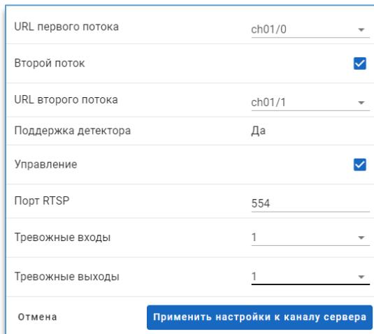
После нажатия на кнопку «Применить настройки к каналу сервера» выбранные опции применяются к каналу. В дальнейшем настройки канала можно изменить отдельно в любой момент.
