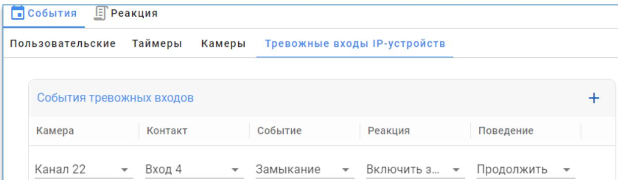
Для создания события нужно нажать на кнопку . В столбце «Камера» нужно указать устройство видеосервера, в столбце «Контакт» указать контакт устройства (может быть несколько), в «Событии» выбрать состояние, на которое нужно реагировать, в «Реакции» указать ту реакцию, которая настроена на вкладке «Реакции» для этого события, в «Поведении» указать тип поведения.
