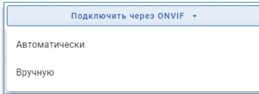
При нажатии на вариант «Автоматически» видеосервер подключит камеру, используя настройки по умолчанию. Тревожные контакты (если они есть) задействованы не будут. Тревожные контакты можно включить только при подключении вручную.
