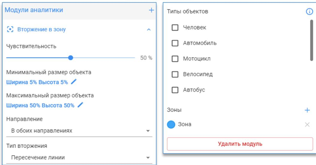
После добавления модуля «Вторжение в зону» на изображении с заранее выбранной для канала камеры отобразится зона, которую можно редактировать, перетаскивая её с помощью мыши за точки на границах зоны.
