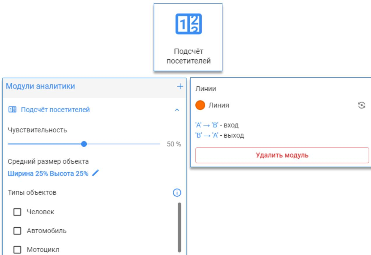
После добавления модуля подсчёта посетителей на изображении с камерой отобразится линия с указанием направления входа. Линию можно перемещать и менять её размер. Объект будет подсчитан, если пересечет линию по направлению «А -> В» и исчезнет из поля зрения камеры.
