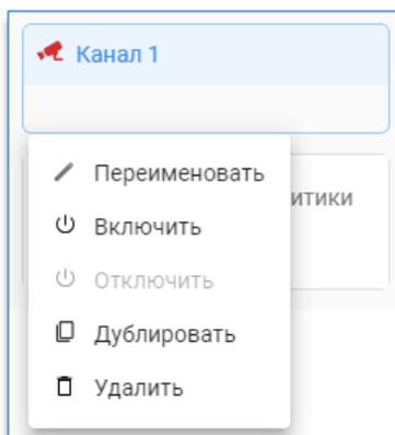
При зажатии клавиши Ctrl или Shift доступно выделение каналов левой кнопкой мыши с целью их одновременного включения, отключения и удаления.
