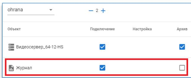
На вкладке «Каналы» для любого канала можно настроить уровень доступа до каждой функции.
